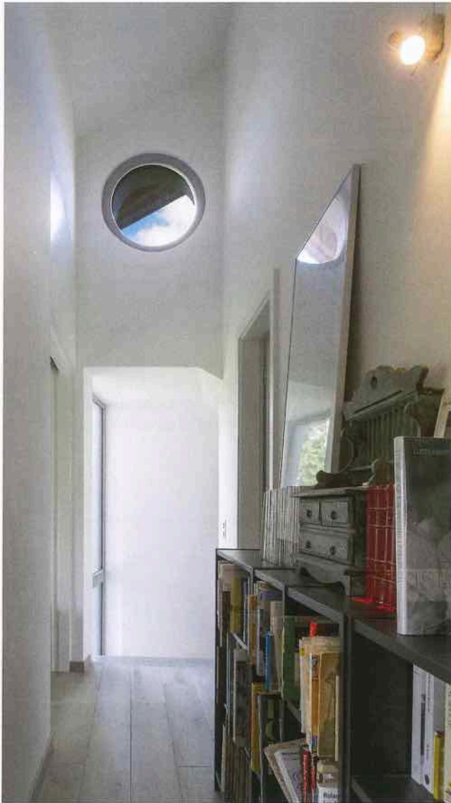
L'apport de lumière dans le couloir est garanti par l'œil-de-bœuf qui fait office de puits de lumière zénithale.
